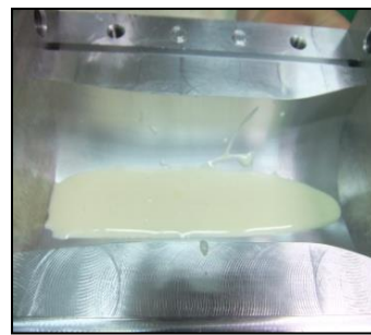
圖 3.12 將發泡倒入模具內
