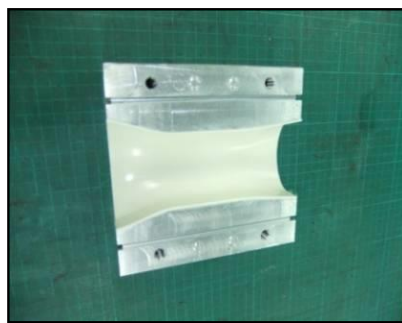
圖 3.15 取出發泡零件
